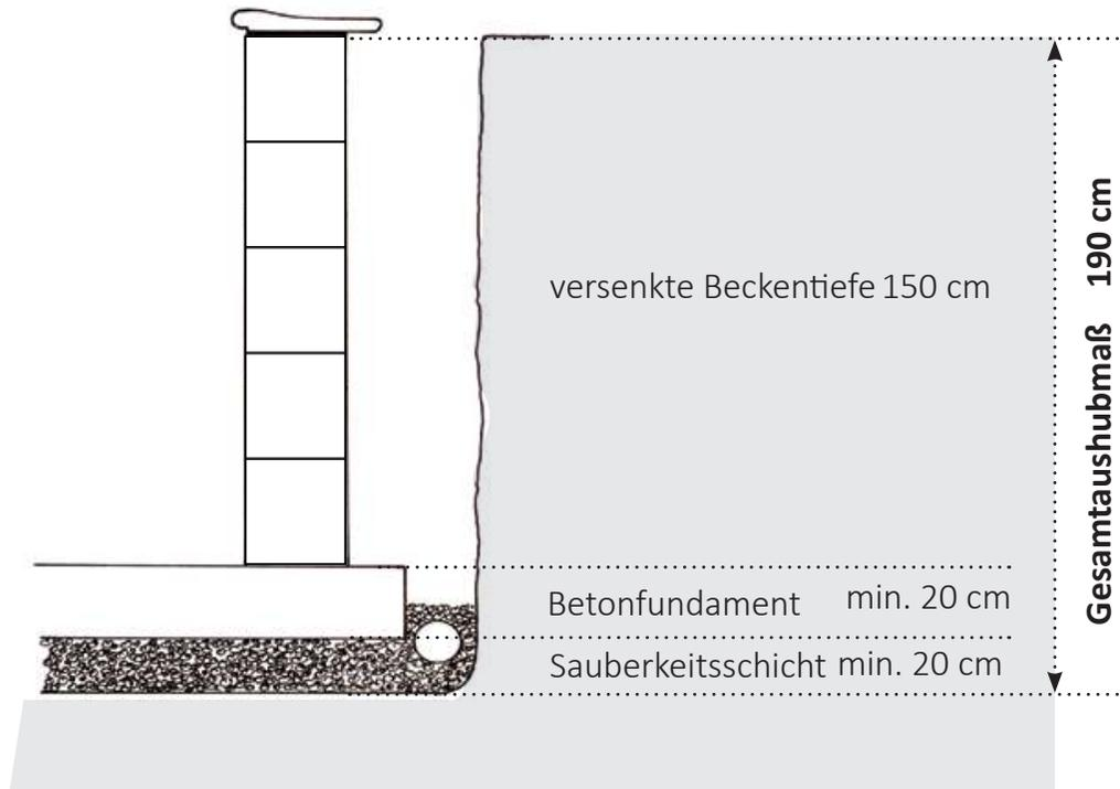
Bevor Sie mit dem Aufbau der Bodenplatte beginnen, empfehlen wir Ihnen die Einbringung einer Sauberkeitsschicht. Diese sollte aus einer 15- 20 cm starken Schicht aus Rollschotter bestehen. Diese Rollierung sollte in Verbindung mit einer Drainage stehen, um Sickerwasser oder eventuell auftretendes Hangwasser ableiten zu können.
