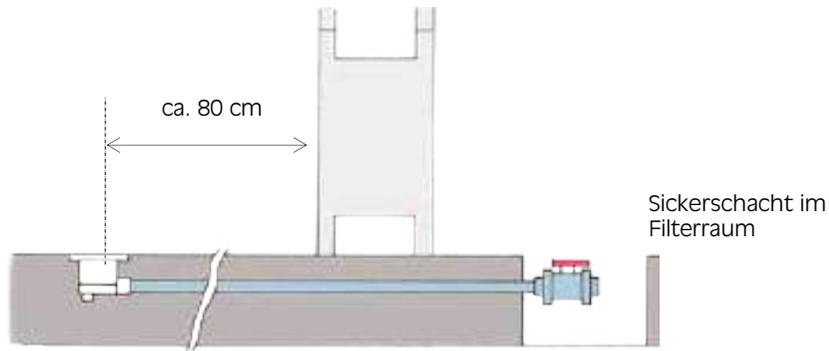
2. Es wird eine separate Schalung (HxBxL) 15cm x 15cm x 180cm errichtet. Der Bodenablauf wird nach der Befüllung der Bodenplatte in dieser Aussparung einbetoniert.
