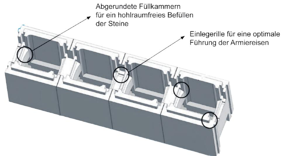
Sind während des Aufmauerns durch zu nassen Beton oder durch zu schnelles Einfüllen des Betons Fugen oder Stöße zwischen den Steinen entstanden, so ist es notwendig, diese mit einer frostsicheren Spachtelmasse und einem Netz zu verspachteln!
